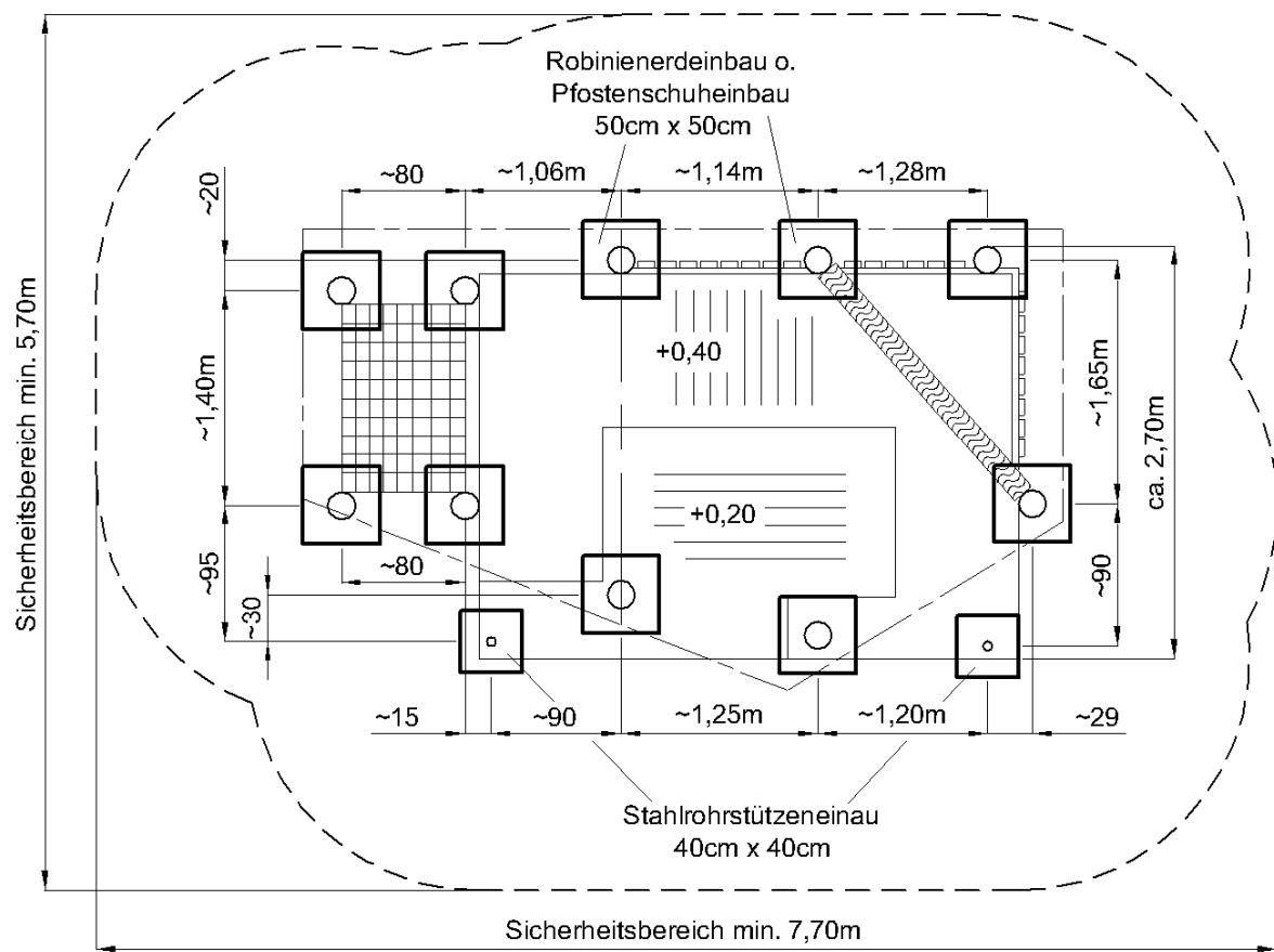
**alle nicht bemaßten Fundamente 50cm x 50cm Robinieerd- bzw. Pfostenschuhleinbau**
